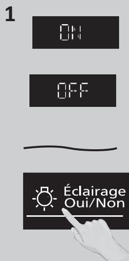
Cette fonction permet de régler la luminosité de la surface de cuisson.
